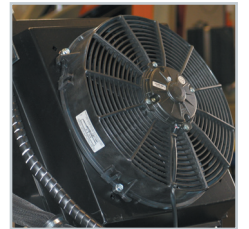
Heat exchanger. Cambiador de calor.
