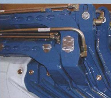
Tutti i cilindri a sfilo singolo. Con sfilo ad alta velocità (STANDARD). Con circuito FULL POWER, massima potenza (OPZIONE).
