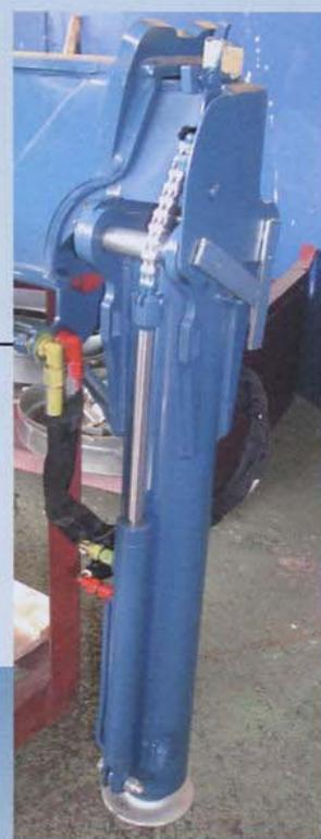
Cilindro stabilizzatore ribaltabile 180° (OPZIONE).
